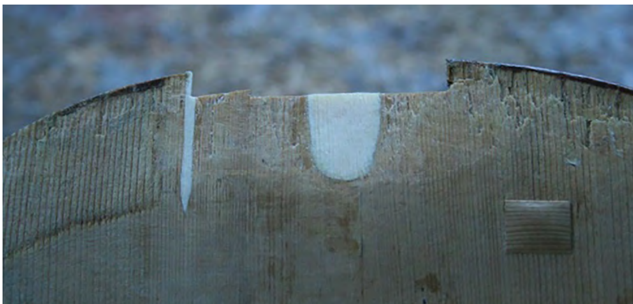
Vysazené místo. Vedlejší prasklina byla z vnitřní strany natolik otevřená, že byla raději vysazena, než aby se místo namáhalo silným stahováním.
