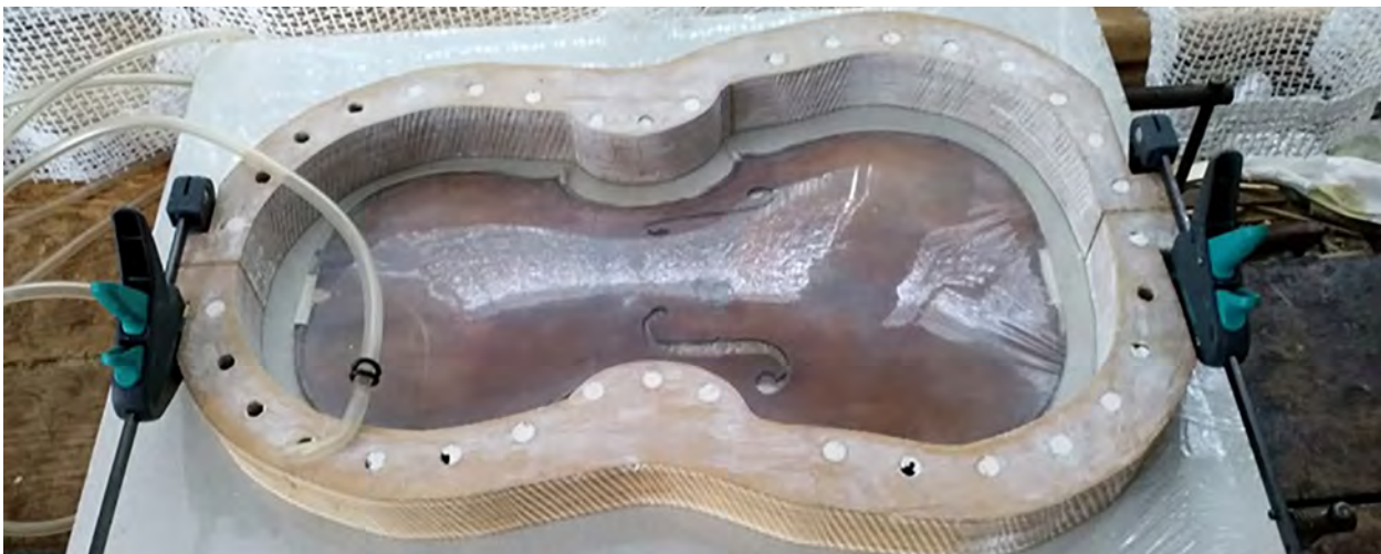
Deska ukotvená na základnu, podepřená zevnitř rýží, zafóliovaná a opatřená rámem, do kterého byla nalita sádra.
