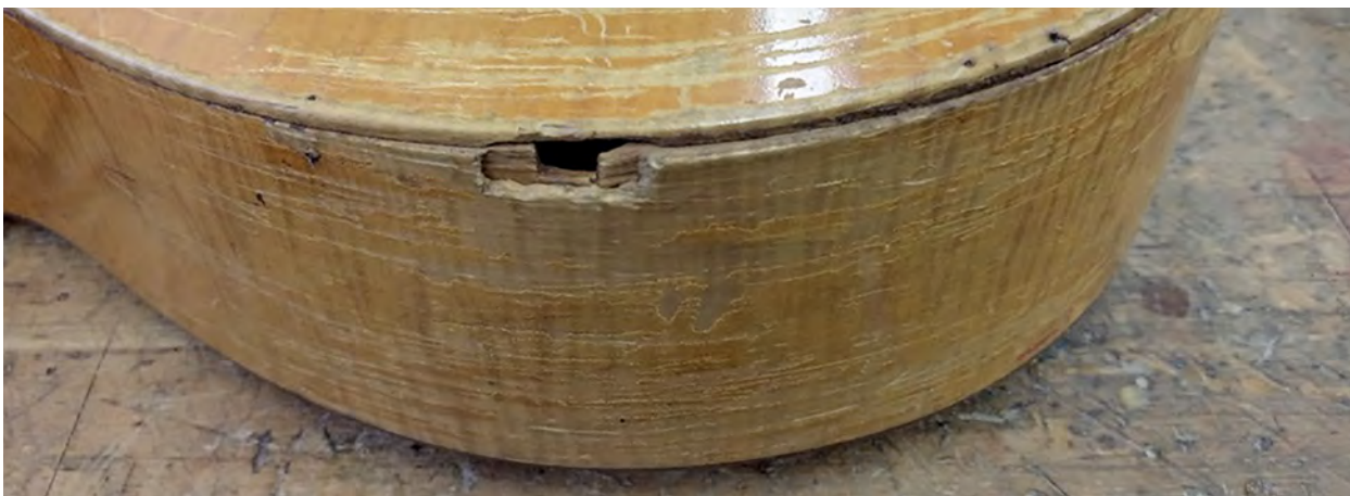
Poškozený kytarový korpus sesycháním a následným protlačením žebra zadní desky skrz lub.
