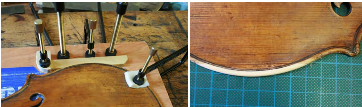
Vysazování opotřebovaného okraje v pravé dolní lici a okraj po začištění.
