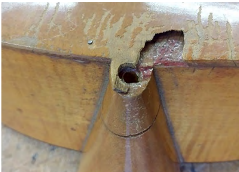
Prasklá patka kytary s následným vylomením zadní desky.
