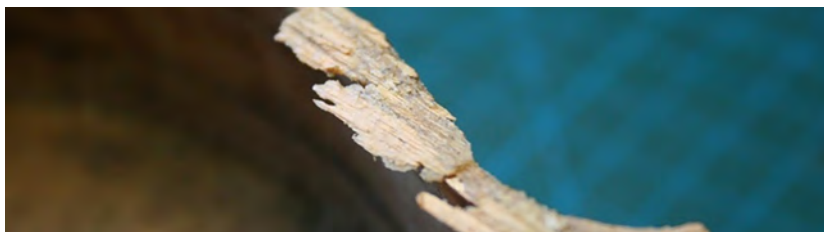
Snímání horní desky. Silná vrstva kliču, která utvořila jakýsi koláč zasahující daleko do desky.
