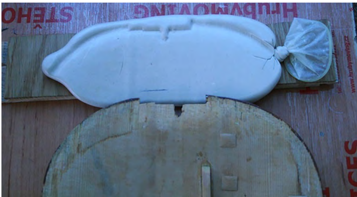
Zhotovení částečného sádrového odlitku
