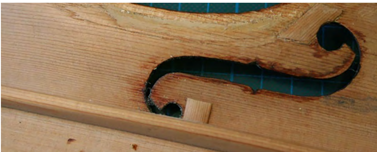
Zde je patrné, jak hluboko byl okraj desky v minulosti vytržen. Rána sahá téměř k effu. A opět tmel. Podlepené praskliny v effu a u basového trámce.
