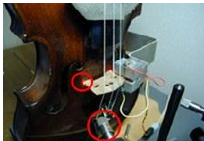
Obr. 4 | Příklad měření snímačem změny polohy bodu (akcelerometr, bodový laser při sinusovém buzení), zaznamenán je časový pohyb bodu na komponentě kobylka (vlevo), rezonanční deska (uprostřed), ze záznamu jsou určeny akustické vlastnosti amplituda, frekvence pohyb bodu a jejich časová změna (tranzientní děj).
