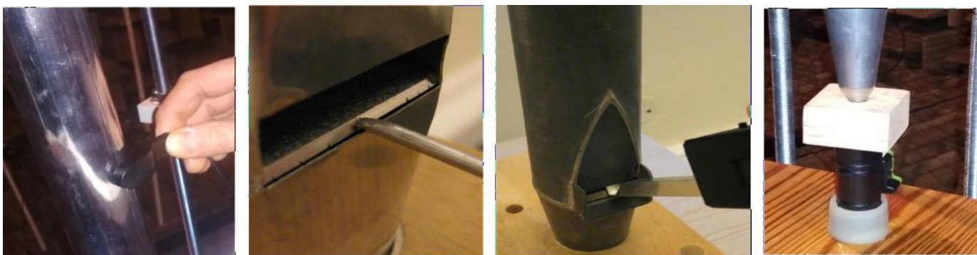
Obr. 17 | Příkladů prostředků vyvinutých pro dokumentace památkově chráněných varhan, které jsou univerzálně použitelných i u dalších druhů zvukových památek. Snímání vibrací komponenty (vlevo), měření rychlosti proudění vzduchu v určitém místě (druhý zleva), měření málo přístupných zvukotvorných sklonů či úkosů (druhý zprava), měření množství proudícího vzduchu (vpravo).
