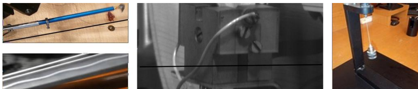
Obr. 8 | Příklad měření akustických vlastností 1D oscilátor - struny (vlastnosti: rychlost šíření průhybu, způsob odrazu při šíření vlny materiálem, amplituda vlny, perioda rotace či kyvu závaží nebo doba k jejich zastavení). Výchylky struny snímáné vysokorychlostní kamerou při buzení impulzem (vlevo), při buzení reproduktorem sinusovým elektrickým proudem (uprostřed), měření ohybových a torzních vlastností struny pomocí kyvadla (vpravo).
