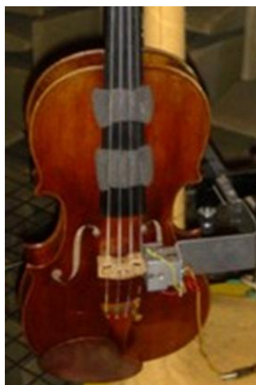
Obr. 3 | Buzení sinusovým signálem vytvářeným počítačem a předávaným na komponenty elektricky vibrujícím reproduktorem (k měření jak samotných komponent, tak i funkčního zdroje zvuku), kobylka houslí (vlevo), celé housle (vpravo).
