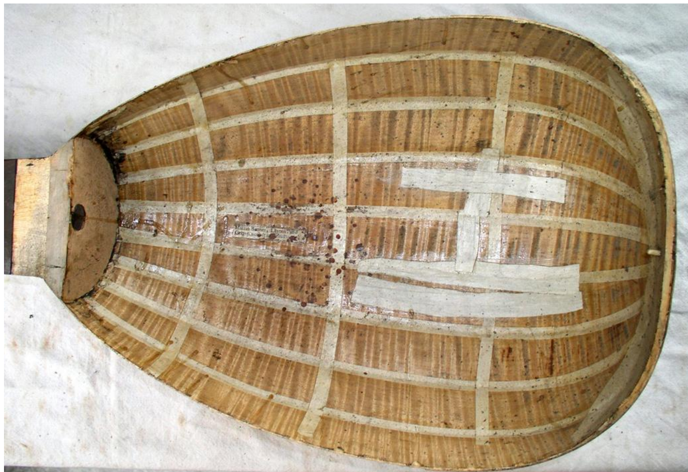
Obr. 9 | Vnitřek korpusu po sejmutí desky, plátěné přelepky v místě proražení korpusu (předchozí oprava). Foto: J. Čepelák.
