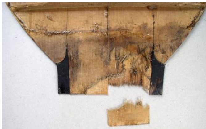
Obr. 7 | Poškození desky vlivem snímání. Foto: J. Čepelák.
