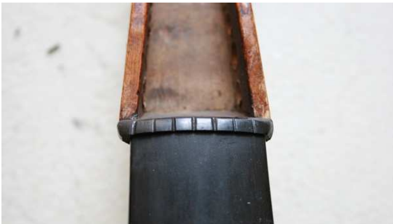
Obr. 22 | Horní pražec měl sedla pro struny rozmístěná zcela mimo osu. Proto jsem nástroj odstrojil, abych zhotovil nový horní pražec.
