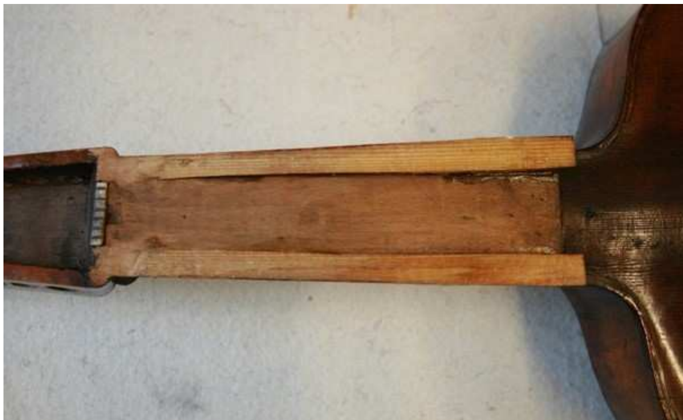
Obr. 23 | Při sejmutí horního pražce jsem zjistil, že hmatník je částečně uvolněný. Rozhodl jsem se ho sejmut také a vyrovnat styčné plochy krku a hmatníku.
