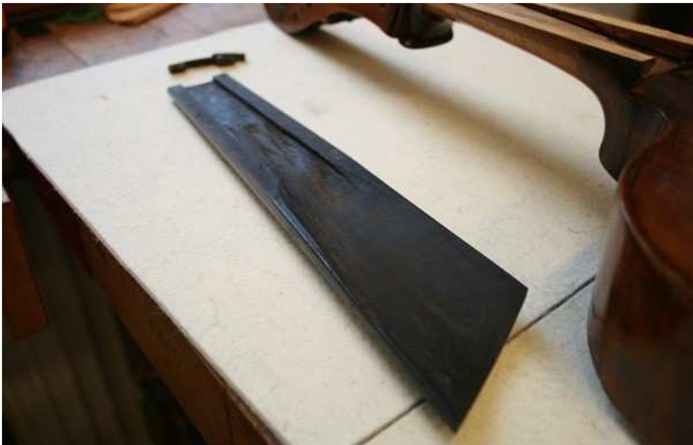
Obr. 26 | Lehce jsem vyrovnal i styčnou plochu hmatníku.
