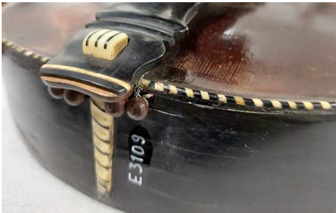
Obr. 11–12 | Objevuje se také dvojí zavěšení struníku. Buď na trn, který je vlepený do věnce u dolního špalíku a probíhá otvorem struníku, nebo zavěšením na žalud.
