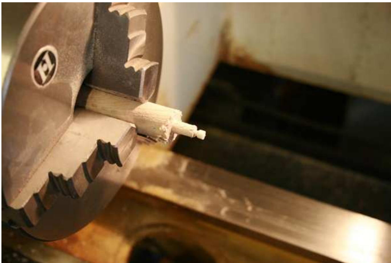
Obr. 21 | Z odříznutého plátku kosti jsem vybrousil přibližně válcový tvar, aby šel upnout do sklíčidla a vysoustružil několik pinů. Dokončení tvaru pinů jsem provedl v jednoduchém upínacím přípravku na soustruhu pilníkem.
