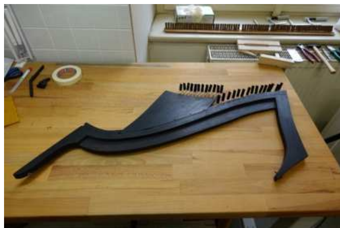
Obr. 22 | Detail zakřivené harmonické lišty s kladívky a její úpravy. Foto A. Bitljan.
