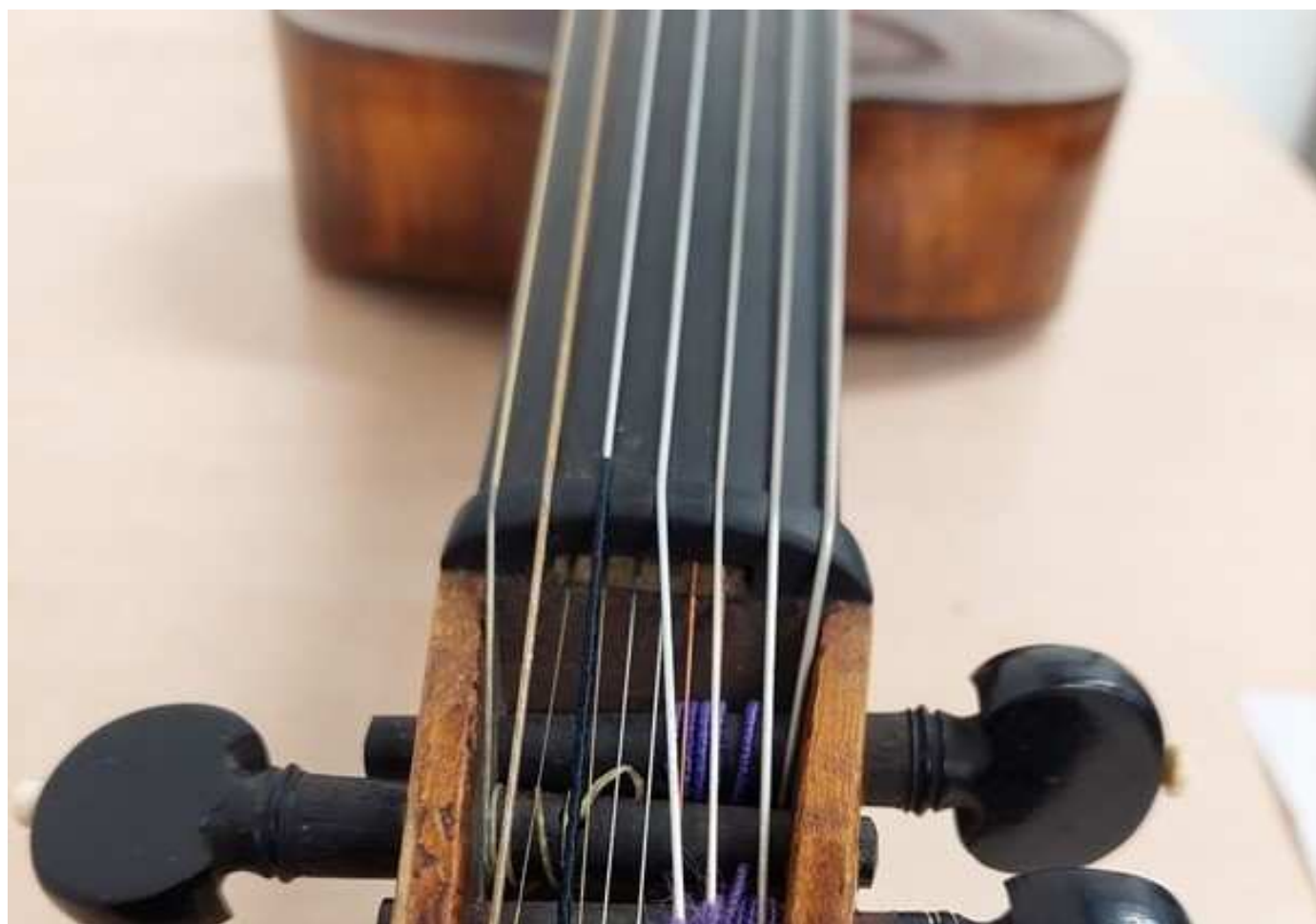
Obr. 38 | Dokončený nový horní pražec a pod ním vyčištěný kostěný pražec.
