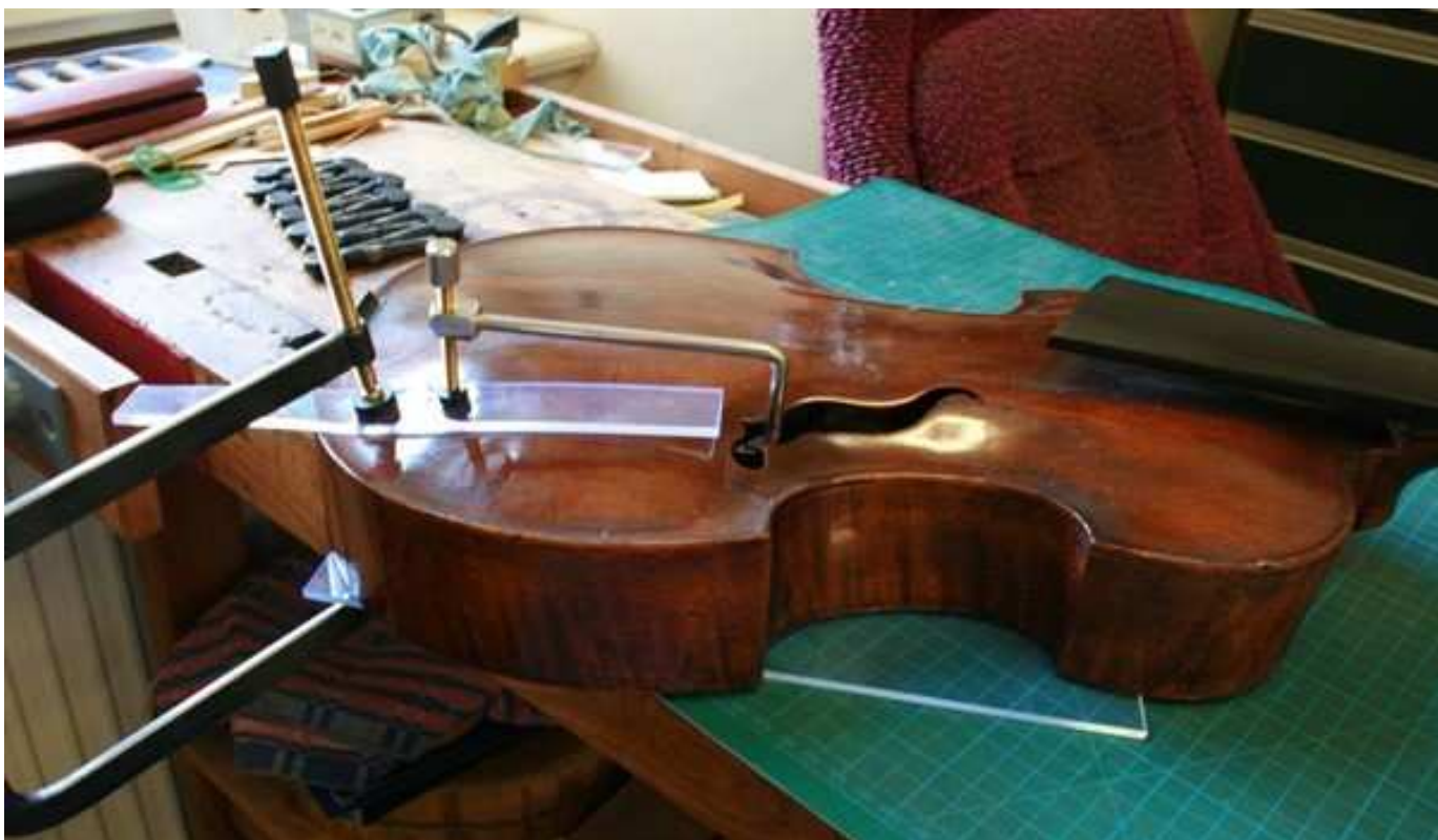
Obr. 28 | Na vrchní desce byla uvolněná trhlina. Tu jsem zaklížil a zároveň jsem prasklinu zajistil podlepkou pomocí speciální svěrky.
