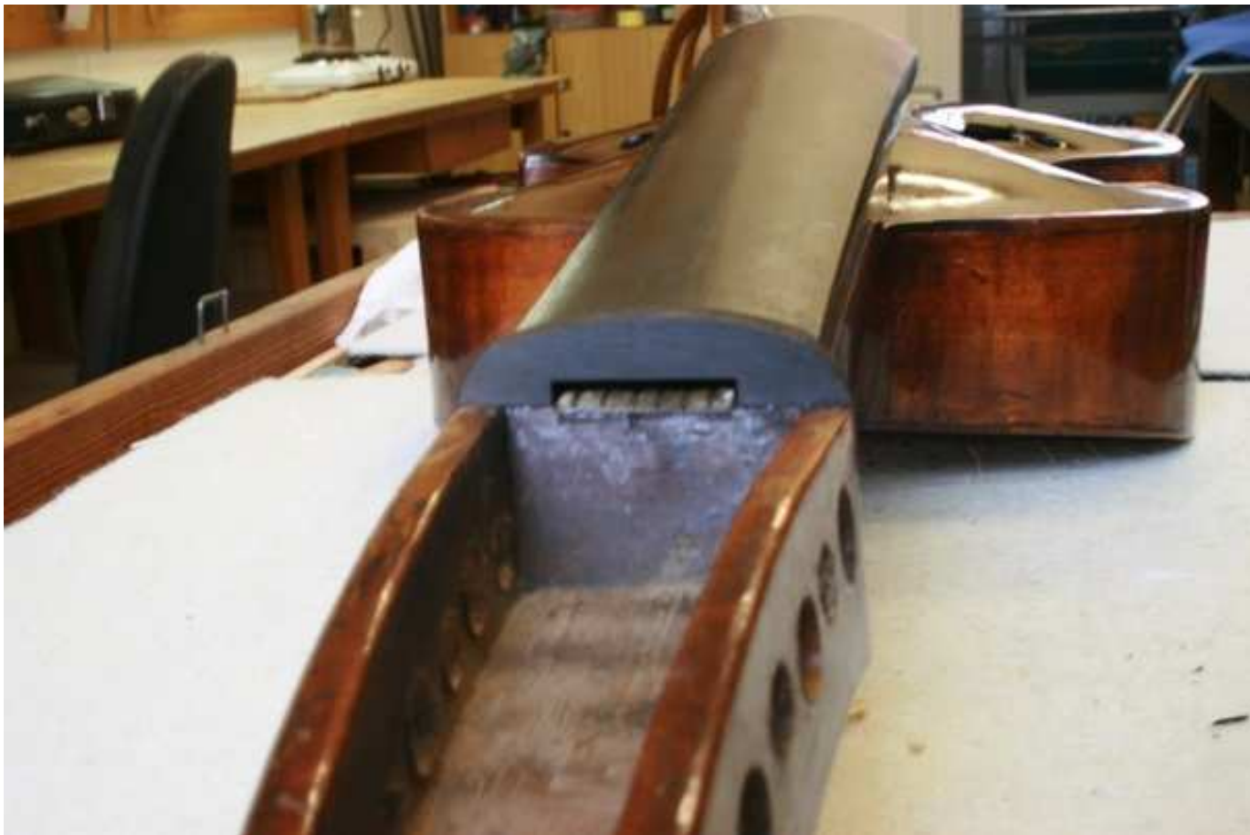
Obr. 27 | Po přiklizení hmatníku jsem vsadil i nový horní pražec.
