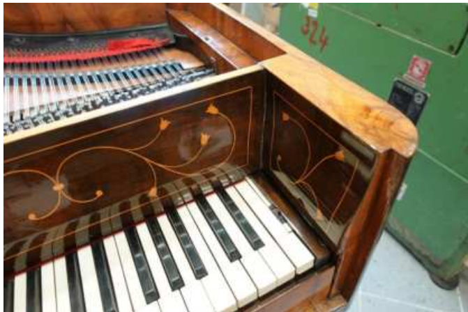
Obr. 30 | Detail ovládaní přepínání mezi hrou na struny klavíru a na varhany. Foto A. Bitljan.
