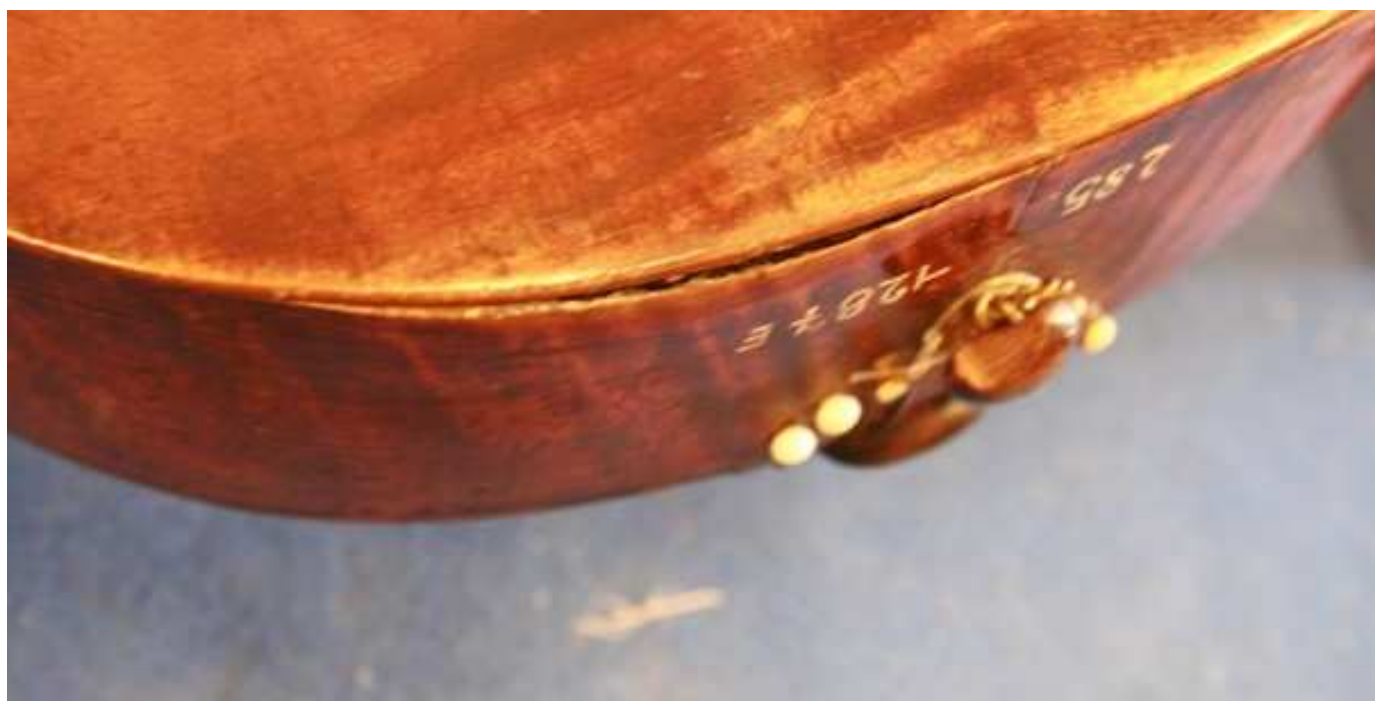
Obr. 30 | Lub v dolním oblouku je vylezlý a předchozí opravou zničený. Je obroušen do ostra. To je bohužel nešvar často se objevující u kytar, kontrabasů a vůbec nástrojů, které mají desky bez přesahu. Opravář nechtěl otevřít korpus a přečnívající luby zkrátit, (je to příliš náročné), tak to prostě zalepil a obrousil. Tím zajistil jen to, že nynější oprava by byla extrémně náročná a drahá. Přitom by stačilo okraj dotmelit. Je to zdánlivě amatérský způsob, ale je vratný, obnažená místa dostatečně ochrání a neubývá při něm původní materiál. Pro toto řešení jsem se rozhodl i já.
