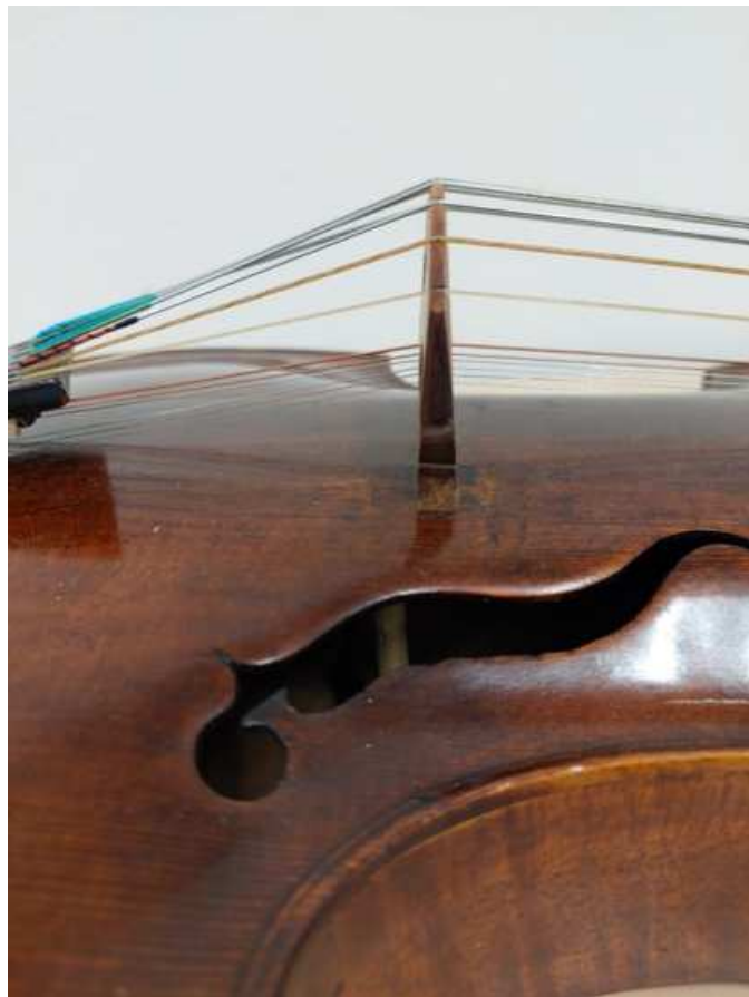
Obr. 40 | Byla dopasována a postavena duše.
