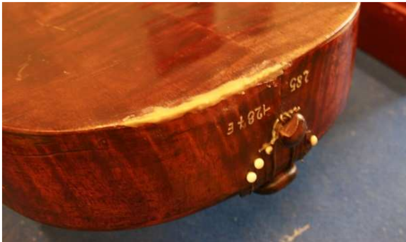
Obr. 31 | Z klihu, javorového obrusu a lycopodia jsem vyrobil tmel, kterým jsem obnažené místo překryl.
