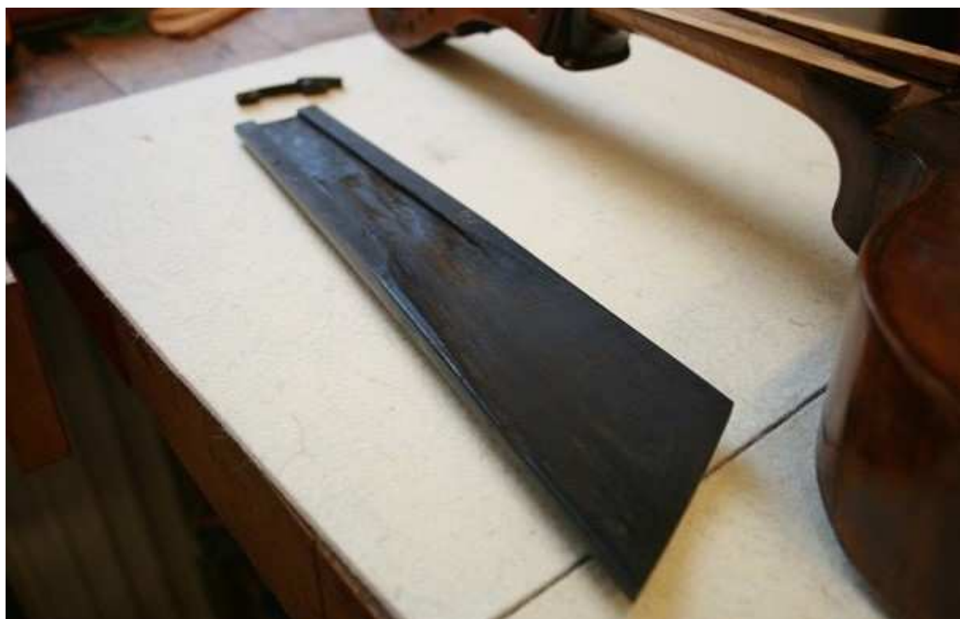
Obr. 26 | Lehce jsem vyrovnal i styčnou plochu hmatníku.
