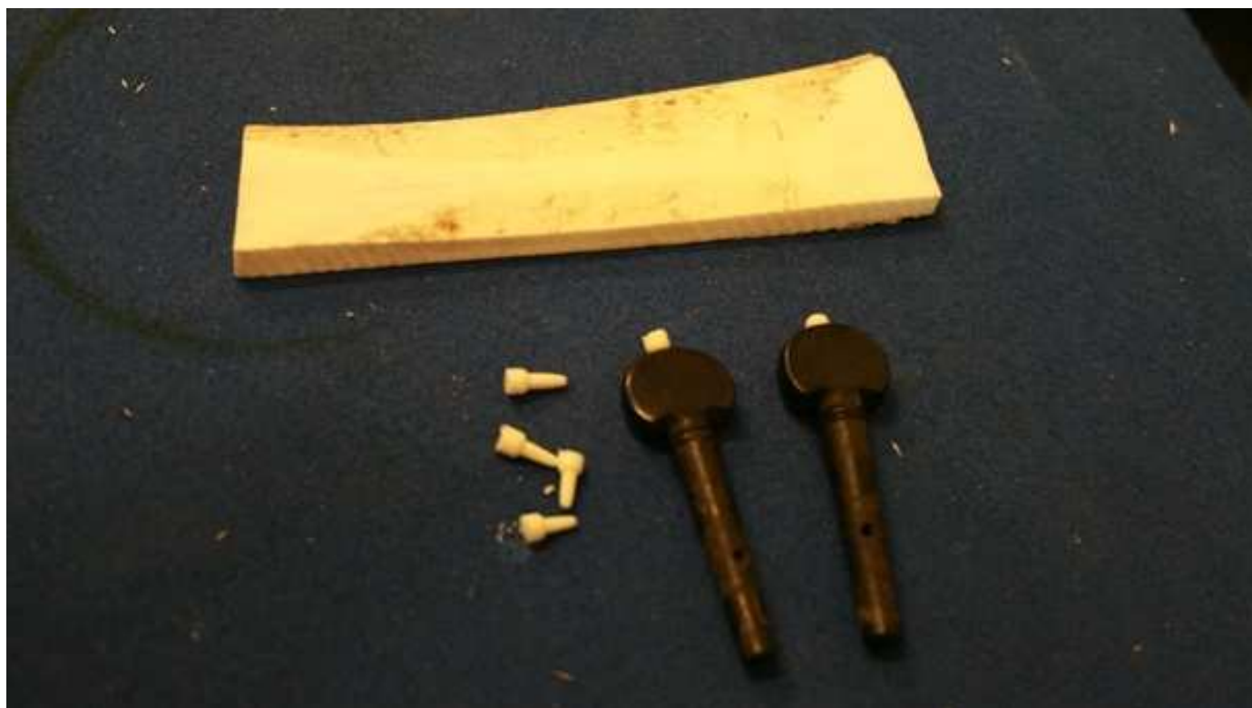
Obr. 20 | Na výrobu závěsů a chybějícího pinu v kolíčku jsem použil hovězí kost. Dva roky před tím jsem jí našel na poli u Mokropsů. Byla sice špinavá, ale pěkně vybělená od mravenců a jiných brouků.
