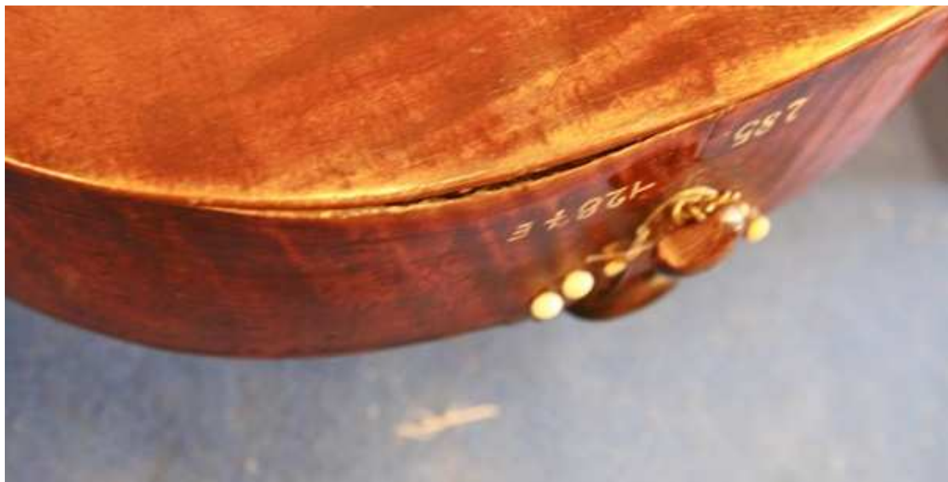
Obr. 30 | Lub v dolním oblouku je vylezlý a předchozí opravou zničený. Je obroušen do ostra. To je bohužel nešvar často se objevující u kytar, kontrabasů a vůbec nástrojů, které mají desky bez přesahu. Opravář nechtěl otevřít korpus a přečnívající luby zkrátit, (je to příliš náročné), tak to prostě zalepil a obrousil. Tím zajistil jen to, že nynější oprava by byla extrémně náročná a drahá. Přitom by stačilo okraj dotmelit. Je to zdánlivě amatérský způsob, ale je vratný, obnažená místa dostatečně ochrání a neubývá při něm původní materiál. Pro toto řešení jsem se rozhodl i já.
